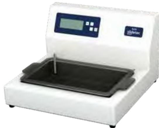
Está diseñado para estirar la parafina secciones y posteriormente secar y hornear estos en microslides. Este instrumento combina funcional diseño con características de seguridad y ergonómicas que mejoran la confiabilidad del proceso y el uso conveniente.
