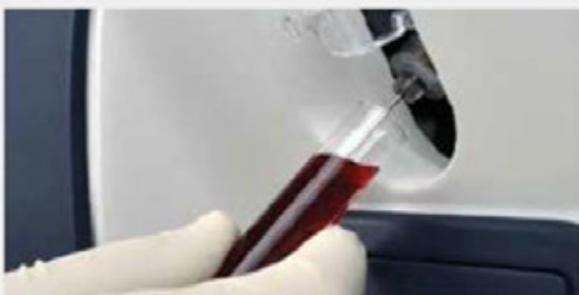
Las muestras pueden ser aspiradas directamente de tubos. La necesidad de pasar la muestra a jeringas o capilares se elimina.
