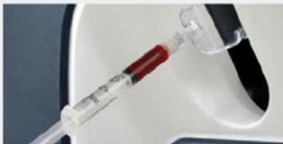
Las jeringas pueden ser enclavadas y muestreadas automáticamente sin necesidad de sostenerlas.
