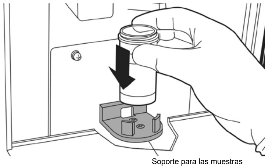
Figura 5A-3 Carga del vial de muestras PreservCyt
